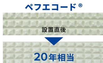
約20年相当分の紫外線照射試験でも 目視での表面劣化は見られません
